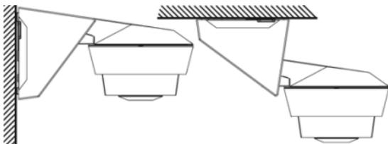
Lösen Sie die 2 Schrauben auf der Vorderseite des Sensors. Danach den Montagesockel vom Sensor abziehen. Den Montagesockel mit den mitgelieferten Schrauben an der gewünschten Position anschrauben. Die Netzzuleitung kann von hinten oder unten eingeführt werden. Schliessen Sie den Sensor gemäss Schema auf Seite 4 und 5 (entsprechend Ihren Bedürfnissen) an. Stecken Sie den Sensor auf den Montagesockel und schrauben diesen wieder mit den 2 Schrauben fest.
